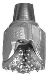
La **percusión** es la más sencilla (cable y trépano que golpea) y es lenta pero efectiva para profundidades moderadas (<150 m) y en ciertas rocas. En la **rotación** un *tricono* (en la imagen) tritura la roca, extrayéndose los detritus mediante la circulación de agua. La adición de lodos a este agua puede taponar los niveles acuíferos atravesados.
