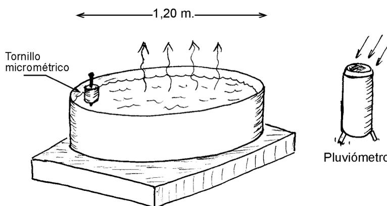
A partir de la medida de evaporación del tanque, se evalúa el valor equivalente de ETP ó  $ET_0$  multiplicando por un *coeficiente del tanque*. Este coeficiente es variable, pero generalmente oscila entre 0,6 y 0,85 (Allen et al. 2006, pág. 81)
