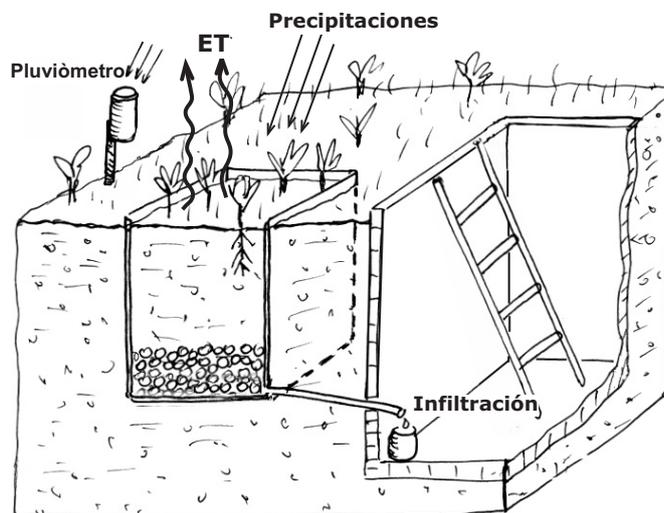
La evapotranspiración se mide mediante **lisímetros**. Consiste en un recipiente enterrado y cerrado lateralmente, de modo que el agua drenada por gravedad (la que se hubiera infiltrado hasta el acuífero) es recogida por un drenaje. En su construcción hay que ser muy cuidadoso de restituir el suelo que se excavó en unas condiciones lo más similares posible a las que se encontraba. Próximo a él debe existir un pluviómetro.
